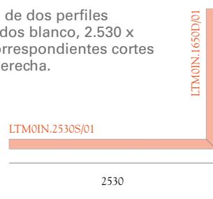
"L"-förmige Zusammenstellung von zwei MINIFILE-Einbauleuchtenprofilen in weiß, 2.530 x 1.650 mm, jeweils mit 45°-Gehrungsschnitt rechts bzw. links.
